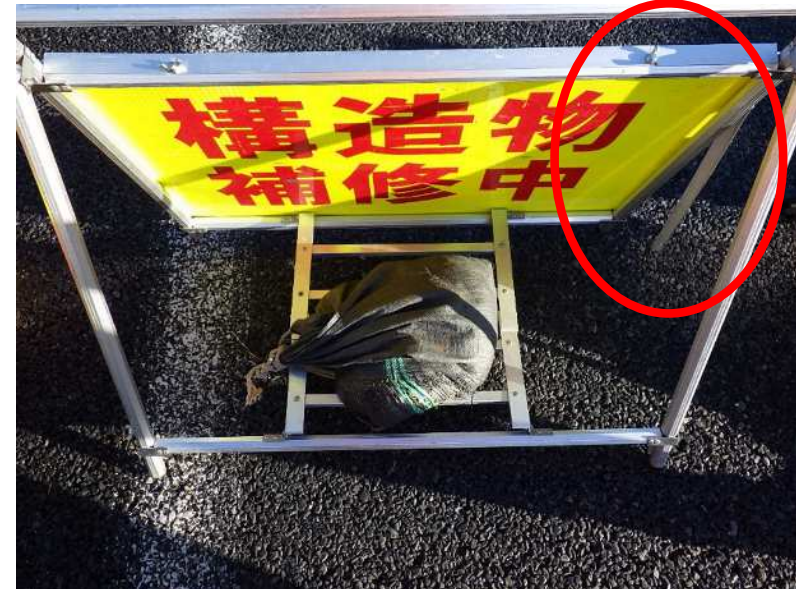
規制看板:看板の外れ止め損傷
